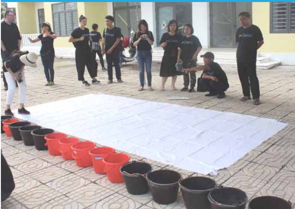
Ảnh 1. Ví dụ tiêu biểu về cách bố trí khu vực phân loại rác khi Đánh giá rác thải
